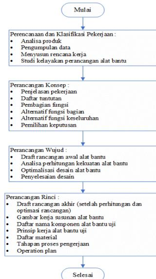
Gambar 3.2 Diagram Alir Metoda Perancangan VDI 2221
